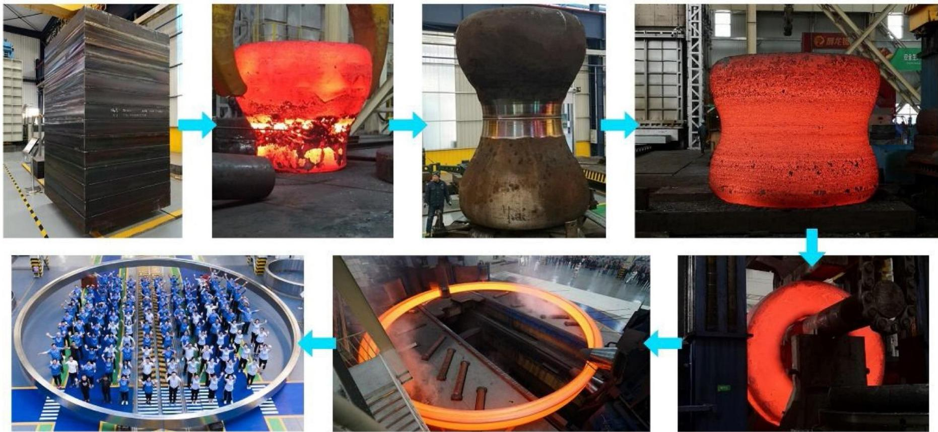
多层热压粘结法制造支撑环的工艺, Sun et al., J. Mater. Sci. Tech., 2021
